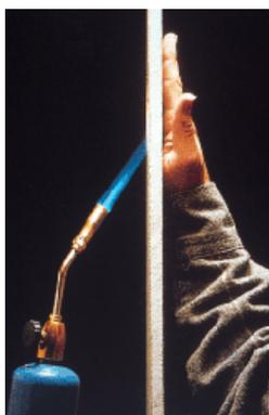
Al exponer una placa de yeso al fuego, el agua contenida en el núcleo de la misma es lentamente liberada como vapor retardando la transmisión de calor a la cara no expuesta a la llama, donde se mantiene una baja temperatura.
