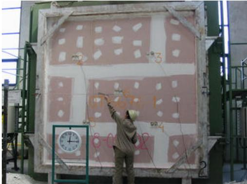
El comportamiento al fuego de los distintos tipos de paredes construidas con placas de yeso se evalúa mediante ensayos realizados bajo Norma IRAM 11950.
